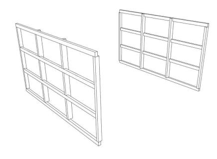
Imagen 2: Une los dos módulos 1 con la ayuda de 4 listones (45x70x2910 mm). Asegura cada listón con 2 tornillos para listones en cada lado corto (total de 16).
