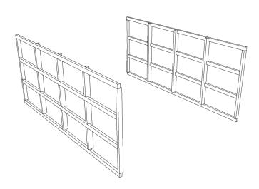
**Bild 2:**Befestige die 2 Module 1 mit 4 Bolzen (45 x 70 x 2910 mm) aneinander. Befestige jedes Lineal mit zwei Linealschrauben an jeder kurzen Seite (insgesamt 16).
