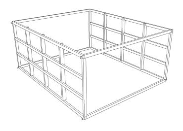
**Bild 3:**Platziere Modul 2 (die horizontalen Bolzen an Modul 2 sollten 1432 mm von den horizontalen Bolzen an Modul 1 entfernt sein). Befestige jedes Lineal mit 2 Linealschrauben an jeder kurzen Seite (insgesamt 8 durchgehend und 8 an der Diagonale).
