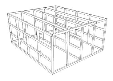
**Bild 5:**Befestige Modul 3 mit 2 Regulierungsschrauben auf jeder Seite der Regulierungskarte (8 Stück pro Modul 3, insgesamt 192 Stück).
